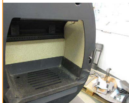
Unieść płytę nad płytami bocznymi
