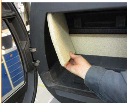
Dopasować ułożenie bocznej lewej płyty zaczynając od góry
