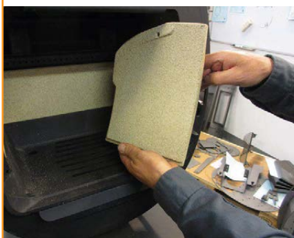
Zamontować boczną prawą płytę zaczynając od góry
