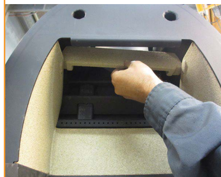
Unieść płytę nad płytami bocznymi
