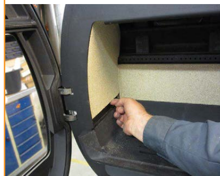
Boczna prawa płyta zamontowana
