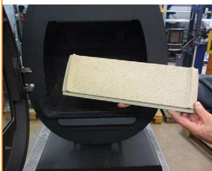
Dopasować ułożenie bocznej lewej płyty zaczynając od góry
