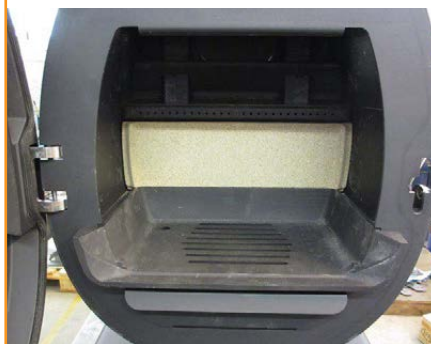
Boczna lewa płyta zamontowana
