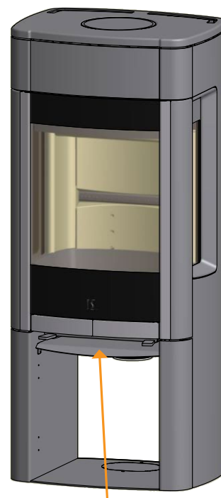
Nie demontować płyty dolnej konwekcyjnej
